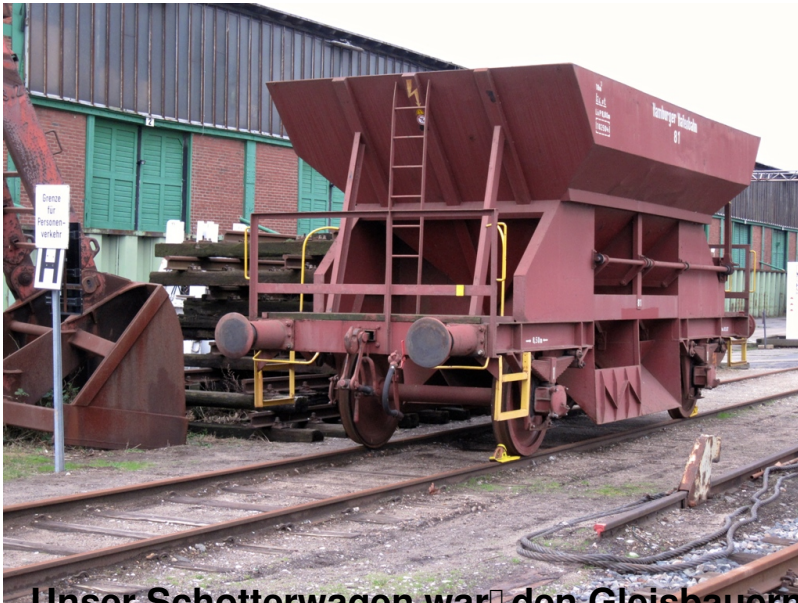
Unser Schotterwagen war für den Gleisbauern eine große Hilfe. In ihm befand sich n
