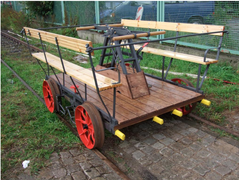
Aufgearbeitet 2007 Bis auf den Rahmen wurde alles Holz erneuert
