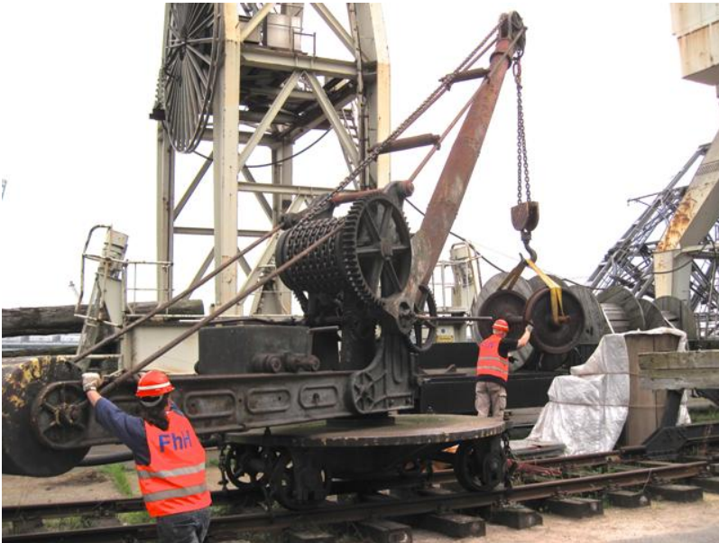
Jetzt auch wieder mit Kette statt Seil, nach 144 Jahren beim Umladen einer Achse
