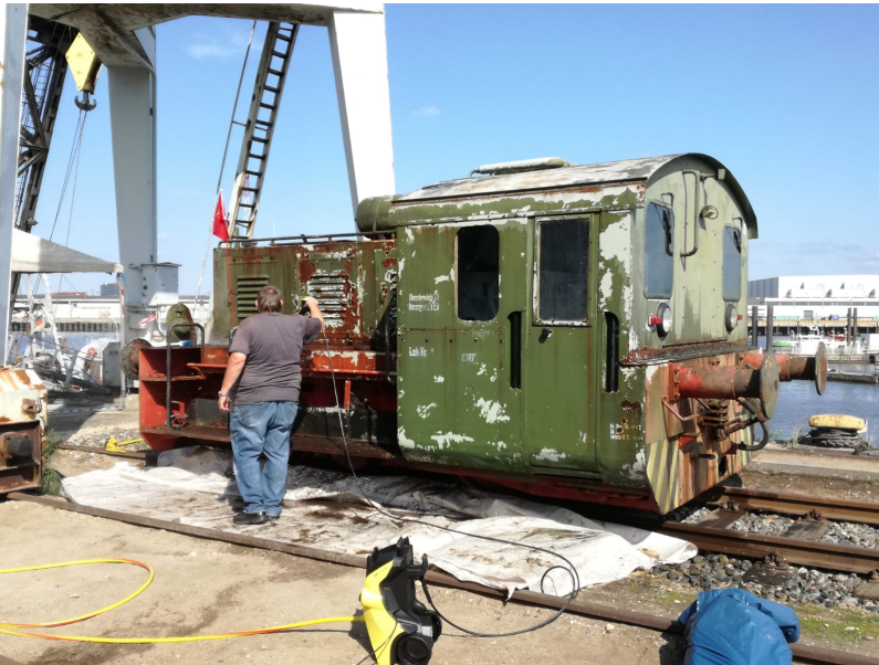
...wurde gleich mit einem Hochdruckreiniger der Grünspan entfernt. Da wartet nun
