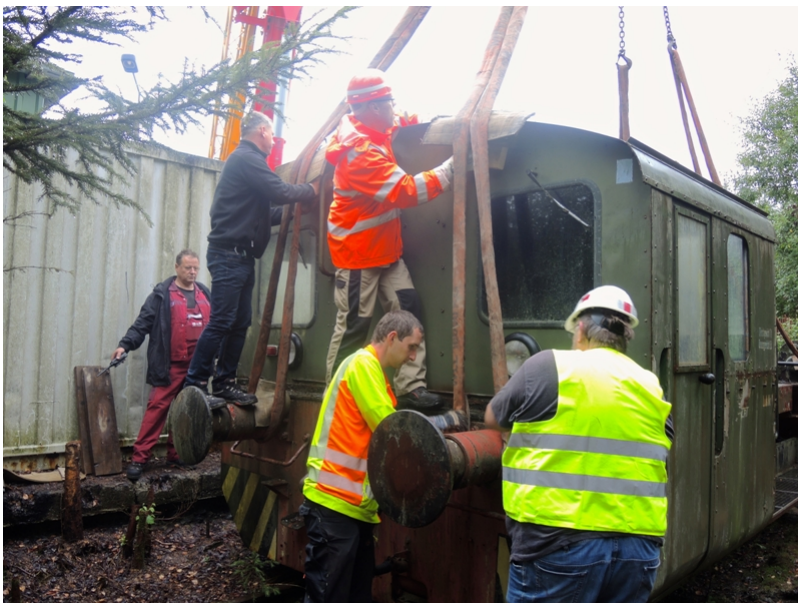
Die Schwerlastgurte wurden angelegt
