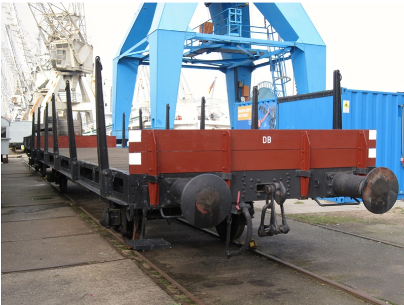
In 2015/16 musste die Beplankung erneuert werden, Fertigstellung mit Beschriftung
