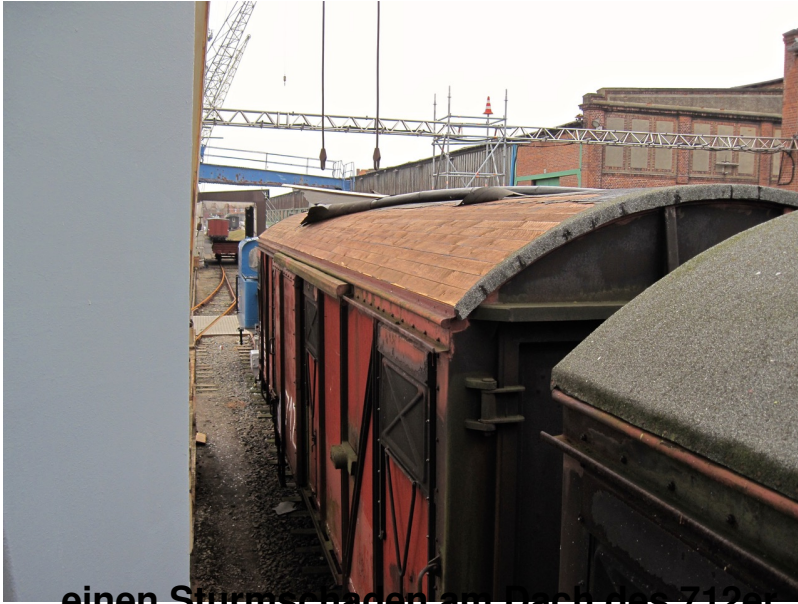
...einen Sturmschaden am Dach des 712er
