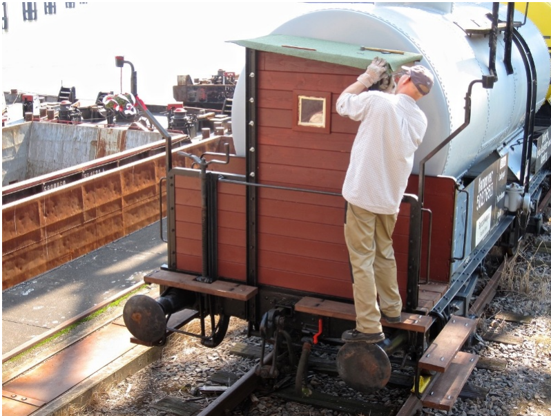
...und das Dach neu gedeckt
