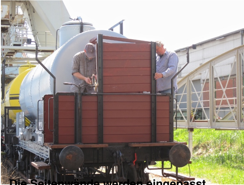
Die Seitenwände werden eingepasst...
