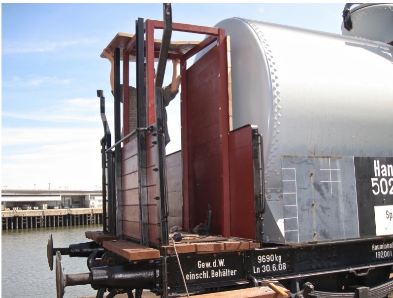
Wir machten uns daher 2015 an die Arbeit das Bremserhaus mit neuem Holz wieder
